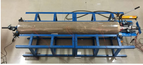
(c) 水泥土锚杆拉拔模型试验
