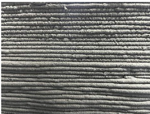
图1 3D打印混凝土的典型侧面
